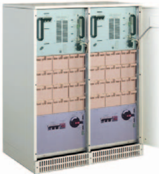
Das Rack der Classic-line nimmt ein USV-Modul von 10 bis 40 kVA mit Batterien auf. Gesamtleistung pro Schrank: bis zu 40 kVA
