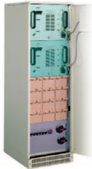
Das Rack der Gemini-line nimmt zwei dreiphasige Module von 10 bis 30 kVA mit Batterien auf. Gesamtleistung pro Schrank: bis zu 60 kVA
